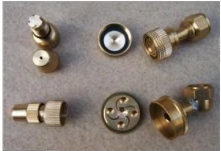
Vòi phun dạng nón có thể điều chỉnh được: Lô vòi phun có bội số của 4 (dưới cùng bên phải) được mở ra để hiển thị buồng xoáy: nó sẽ có một tốc độ vòi phun rất cao.
